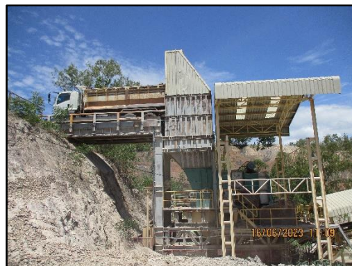
ภาพที่ 2.44 หลังคาปิดคลุมบริเวณ Hopper
