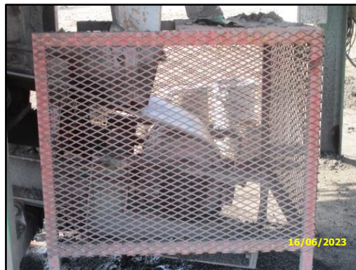
ภาพที่ 2.30 ตัวอย่างสายพานระบบปิด บริเวณที่มีเครื่องจักรเคลื่อนไหว
